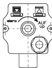
Linkseinbau ist bei JAR-Antrieben nicht möglich.
