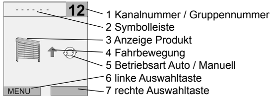
Abb. 1 Display im Betriebsmodus (Beispiel 1): Kanal 12, eingelernte Jalousie, Automatik aktiv, Fahrbewegung AUF
